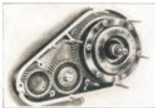
INDIAN Kraftübertragung durch Schneckenräder bei den INDIAN SCOUT und CHIEF Modellen. Diese Kraftübertragung vermeidet die Anwendung der kurzen Ketten und ist dauerhafter als das Motorrad selbst.
