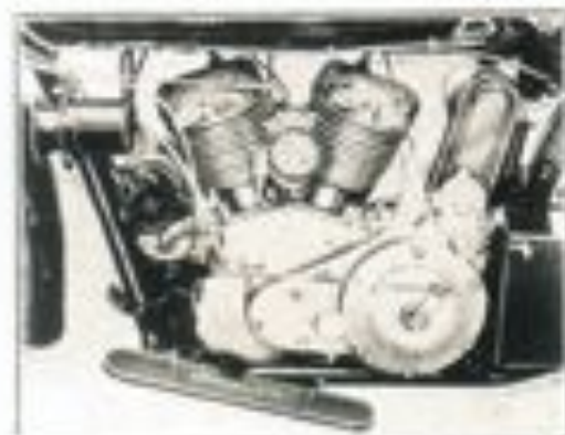
Vollständiges Kraftaggregat. Die Abbildung zeigt Motor, Zahnradgehäuse und Gehäuse aller in einem Block.
